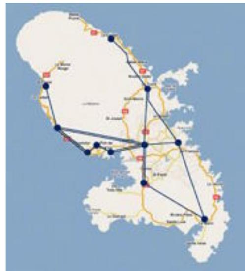
*Réseau de distribution de l'énergie électrique (Source EDF)*
