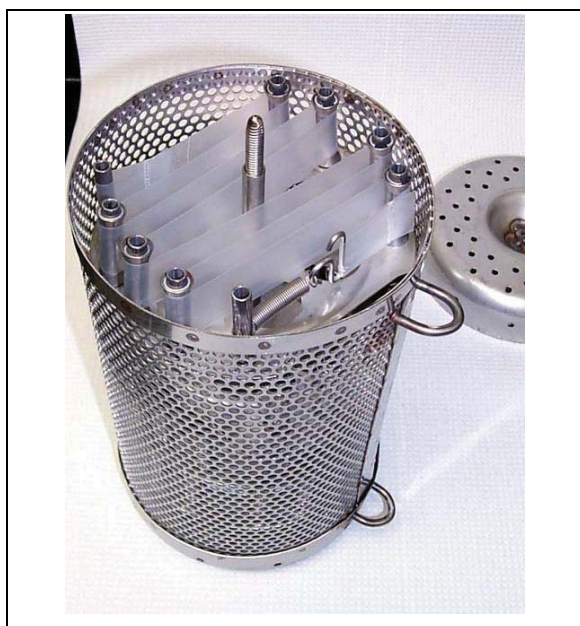
Photo 4. Système d'échantillonneur passif : SPDM dans son carter
