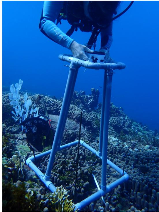
Figure 26. Structure mise en place pour améliorer le suivi par photoquadrats
