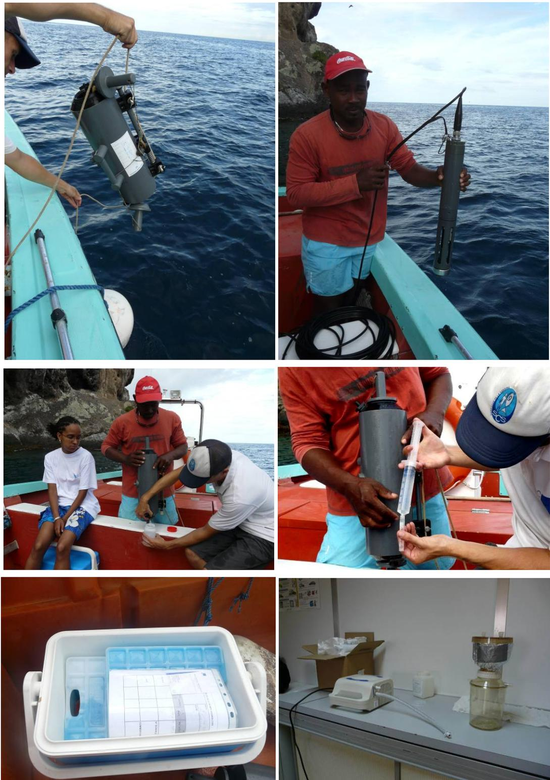
Figure 2: Prélèvement d'eau avec une bouteille Niskin et mesure des paramètres physico-chimiques
